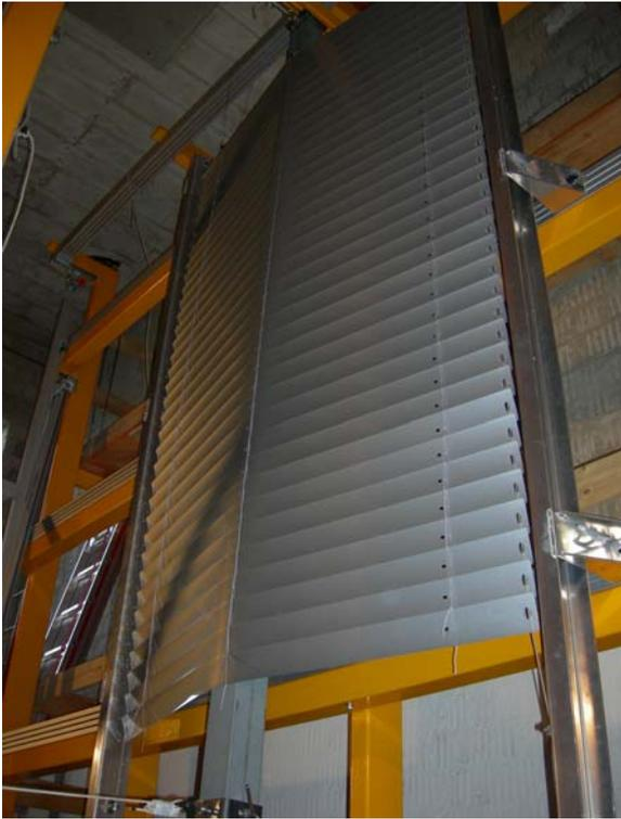
*Abbildung 6: Testversuch an Raffflamelenstoren zur Ermittlung der maximalen Windlast (Quelle: Egli Engineering)*
